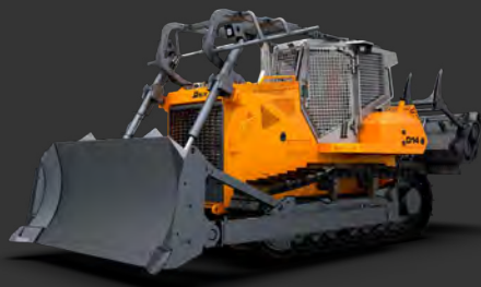
Бульдозер D14 с мульчерной установкой
