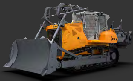
Бульдозер D12 с мульчерной установкой
